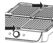
Nađite dugmad za oslobađanje ploča na prednjoj strani aparata. Snažno pritisnite dugme, usled čega će se ploča malo odvojiti od postolja. Uхватite ploču obema rukama, izvucite je iz metalne pregrade i podignite sa postolja. Pritisnite drugo dugme za oslobađanje ploče kako biste i drugu ploču uklonili na isti način.
